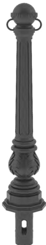
**MOSCA** Dissuasore stradale in ghisa, stile MOSCA, di altezza 1000 mm dal piano di calpestio, base 200 mm costituito da un colonnino cilindrico cavo con 8 scanalature verticali esterne, ornato alla sommità da una testa di forma sferica e, in opzione, nella parte alta da 2 anelli diametralmente opposti per l'eventuale aggancio di catene e nella parte bassa da decorazioni floreali a calice. Base ottagonale con apposita zoccolatura per l'ancoraggio fisso in fondazione.
