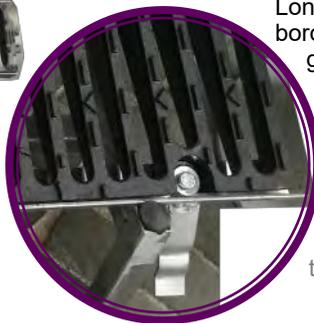
Longherone in acciaio zincato, per la protezione dei bordi esposti al traffico delle canalette in calcestruzzo gettate in opera, costituito da profilato sagomato ad "L" con zanche di fissaggio, fori per eventuale bullonatura delle griglie.
