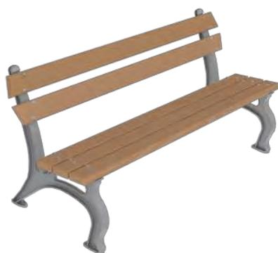
**LISBONA** Panchina stile Lisbona costituita da 2 strutture di sostegno in ghisa con zoccolature alla base predisposte per l'appoggio al terreno; lunghezza 1800 mm, larghezza 730 mm altezza 845 mm. Seduta e spalliera realizzate mediante 5 doghe ad angoli smussati in legno massello Pino russo stagionato trattato per ambienti esterni di sezione 1800 mm (lunghezza) x 110 mm (larghezza) x 40 mm (spessore) da forare per l'opportuno fissaggio ai sostegni con bulloni.
