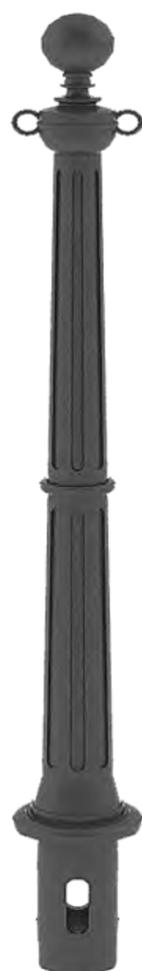
**VIENNA** Dissuasore stradale in ghisa, stile VIENNA, di altezza 1100 mm dal piano di calpestio, base Ø 145 mm, costituito da un colonnino cavo a corpo tronco-conico con scanalature verticali esterne e, in opzione, dotato nella parte alta di 2 anelli diametralmente opposti per l'eventuale aggancio di catene. Ornato alla sommità da un pomello sferico sostenuto da un collarino di forma cilindrica. Base circolare con apposita zoccolatura per l'ancoraggio fisso in fondazione.
